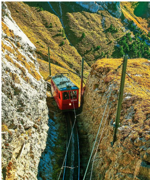
Pilatusbahn: Die mit einer Neigung von 48 Prozent steilste Zahnradbahn der Welt wurde 1889 in Betrieb genommen.
