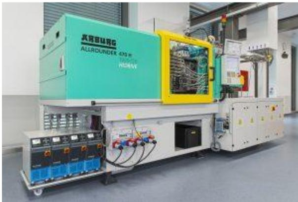
Spritzgießanlage zur Herstellung von Kunststoffteilen der Infusionstherapie. Hergestellt werden unterschiedliche Komponenten, unter anderem Portsysteme und ein Dosierteil an der Schlauchverbindung zwischen Infusionsflasche und Dreivegehahn. Im Einsatz sind pro Anlage jeweils zwischen ein und vier Temperiergeräte. (Bildquelle: HB Therm)
