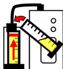
Remplir **exactement jusqu'au niveau** 250 le gobelet 250 placé dans le porte-bidon en y versant le contenu de l'éprouvette 100 ou de l'éprouvette 50.
