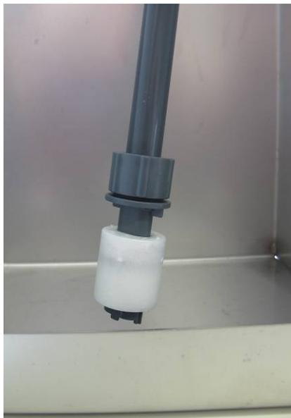
Contrôle électronique du volume minimum avec capteur du niveau bas de remplissage dans le bidon de concentré.
