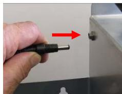
Raccorder sur le doseur automatique la tension de sécurité égale ou inférieure à 24 VDC en connectant la fiche jack avec la prise de l'appareil.
