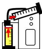
Remplir exactement jusqu'à 250 ml le gobelet 250 placé dans le porte-bidon en versant le contenu du gobelet 100.
