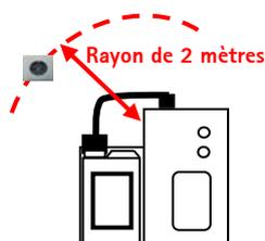
Il est recommandé d'installer si possible au-dessus du doseur la prise de sécurité pour le raccordement du bloc d'alimentation. L'accès à la prise de sécurité doit toujours être assuré. Le câble entre le bloc d'alimentation livré avec l'appareil et le doseur a une longueur maximale de 2 mètres.
