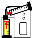
Con il cilindro graduato da 100 ml riempire il cilindro graduato da 250 ml situato sulla mensola per la tanica fino ad arrivare **esattamente a 250 ml**.
