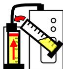
Con il cilindro graduato da 100 ml o con quello da 50 ml riempire il cilindro graduato da 250 ml situato sulla mensola per la tanica arrivando **esattamente alla tacca di 250 ml**.
