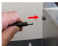
Per allacciare la bassissima tensione di sicurezza (24 VDC) al dosatore automatico si deve collegare il connettore jack all'apposita presa situata sull'apparecchio.
