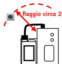
Se possibile, la presa di protezione per l'allacciamento dell'alimentatore a spina deve essere installata al di sopra del dosatore automatico. È necessario garantire sempre l'accessibilità alla presa di protezione. Il cavo dell'alimentatore a spina accluso al dosatore automatico ha una lunghezza max. di 2 metri.
