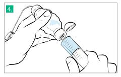
Fixer le dispositif de remplissage sur l'orifice de remplissage.
